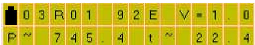
б) вывод плотности и температуры после включения (показания «плывут»);
