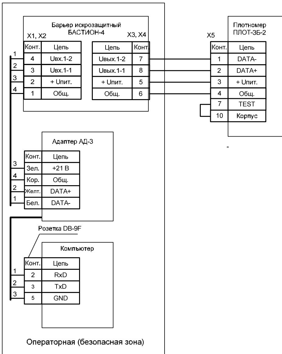
Длина линий связи между плотномером ПЛОТ-ЗБ-2 и барьером искрозащитным БАСТИОН-4 – не более 2000 м.
