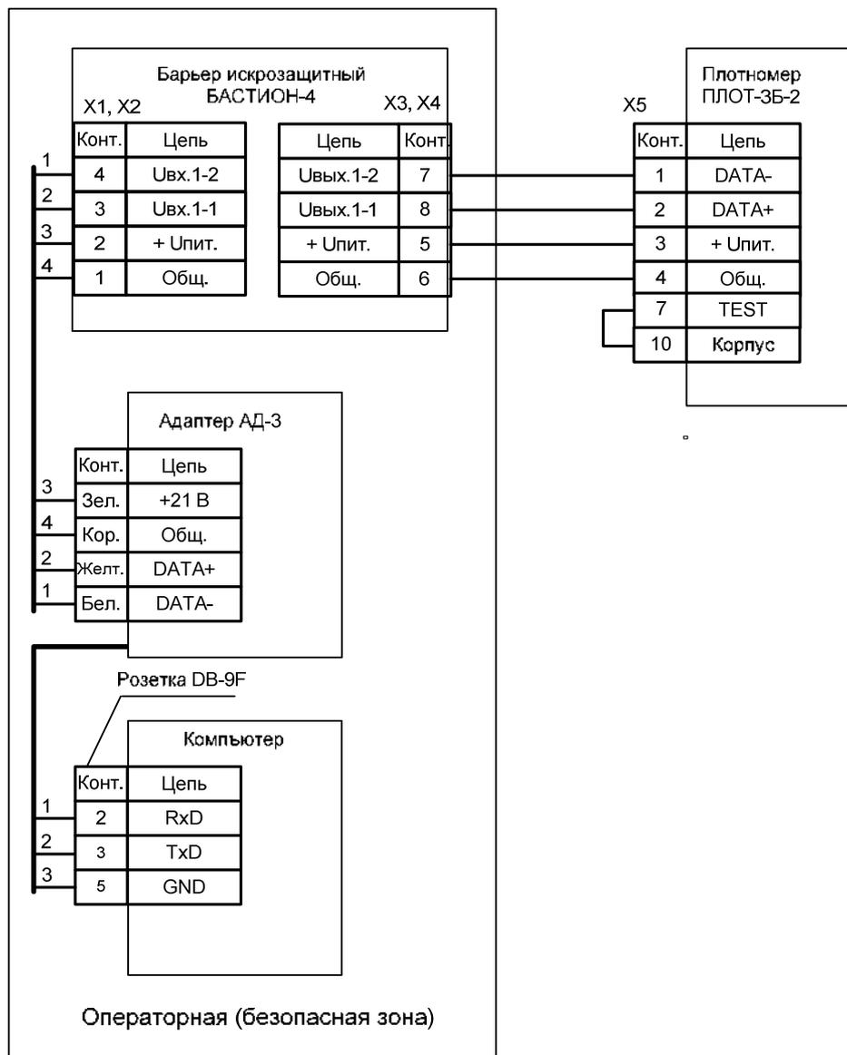
Длина линии связи между плотномером ПЛОТ-ЗБ-2 и барьером искрозащитным БАСТИОН-4 – не более 2000 м.
